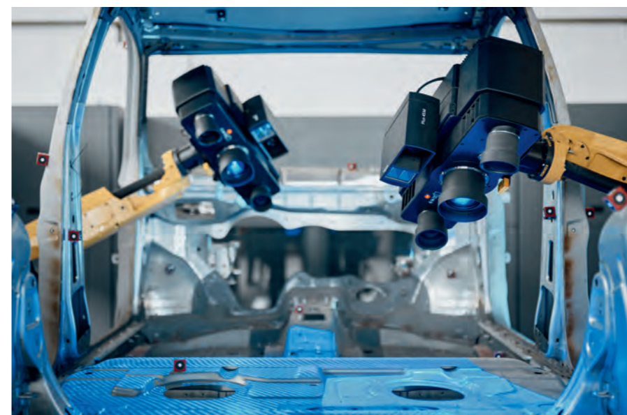
ATOS Sensoren digitalisieren Anbauteile oder sogar komplette Karosserien direkt in der Produktionslinie.
