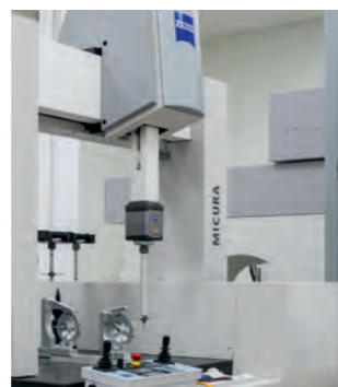
ZEISS MICURA steht im Qualitätslabor und erreicht Genauigkeiten im Submikrometerbereich.
