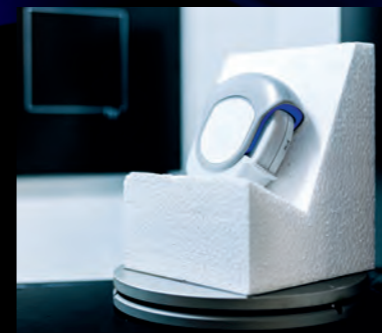
Die Qualität von medizinischen Kunststoffprodukten, z. B. Inhalatoren, lässt sich zerstörungsfrei und schnell mit Computertomografen prüfen.
