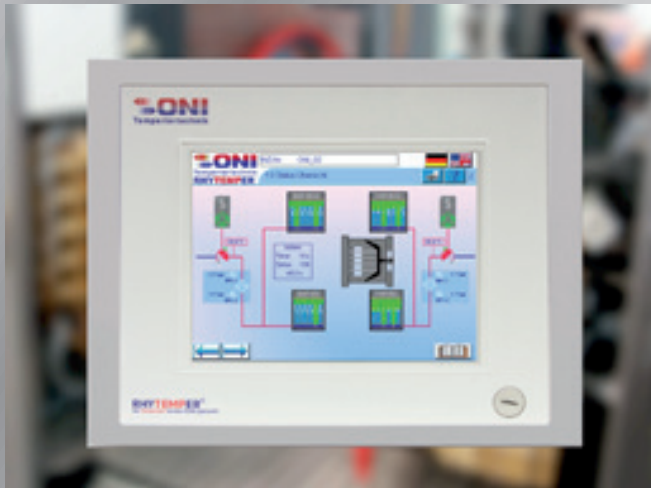
Zentrale Regeleinheit für die kontinuierliche Regelung und Überwachung von Werkzeugkühlkreisen Central controller for a continuous control and monitoring of mould cooling circuits
