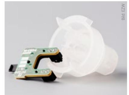
EZW lieferte das Hightech-Spritzgusswerkzeug für diesen Aqua Sensor für Geschirrspüler zur Messung der Wasserqualität.
